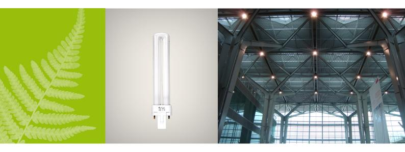
Wirtschaftliche Kompaktleuchtstofflampe in Einrohr-Technik für Einsatz in kompakten Leuchten, z.B. Ein- und Aufbau-Downlights. Die 2-Pin Ausführung (-S) ist für den Betrieb am VVG, die 4-Pin Ausführung (-SE) für den am EVG geeignet. Die 4-Pin-Ausführung kann auch für den Notstrombetrieb (DC) verwendet werden.
